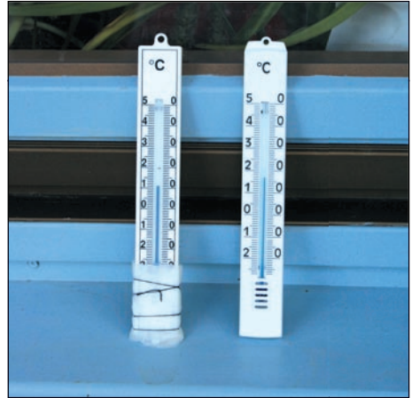
Abb. 32: Die Feuchttemperatur (gemessen mit dem umwickelten Thermometer) ist immer niedriger als die Lufttemperatur
