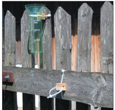
Abb. 48: Montage des Regenmessers. Die obere Aufhängung ist besser, weil der Zaun den Regen ungestört in den Messbecher fallen lässt
