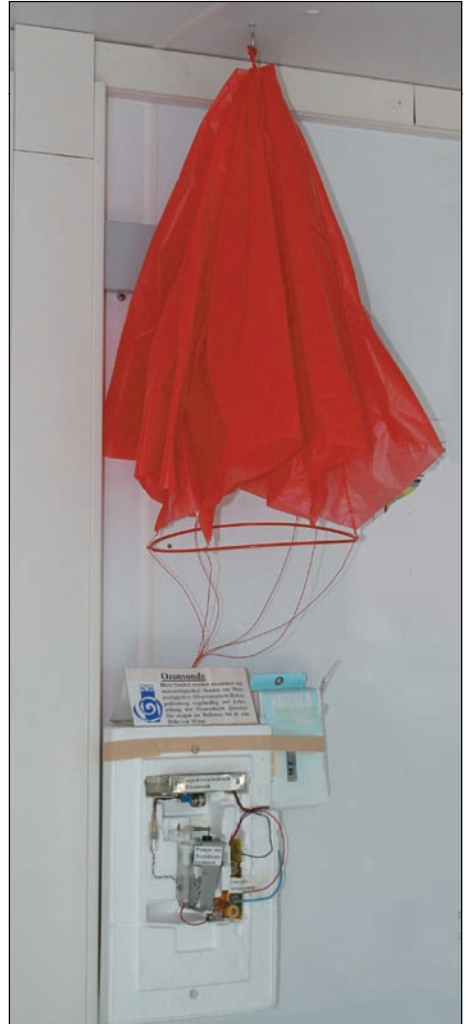
Abb. 60: Eine solche Ozonsonde fliegt bis über 30 Kilometer Höhe und sendet in dieser Zeit Messdaten zur Erde. Platz der Ballon, schwebt die Sonde am Fallschirm herunter
