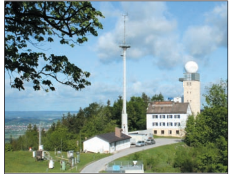
Abb. 57: Observatorium Hohenpeißenberg, mit Blitzregistrierern, Regentropfen-Messfeld, Wetter-Radar (auf dem Turm unter der Kugel versteckt), Windmessgeräten und der Dachterrasse des Hauses, von der aus das Wetter beobachtet wird. Die vielen Messgeräte zur Überwachung der chemischen Luftbeimengungen (zum Beispiel Ozon und Stickoxide) sind nicht zu erkennen.
